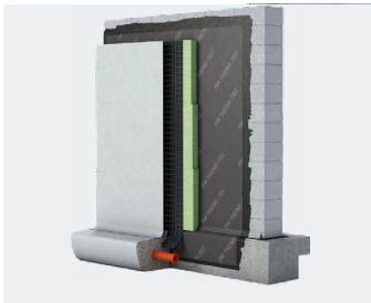
Afdichten grondcontacterende keldermuren
